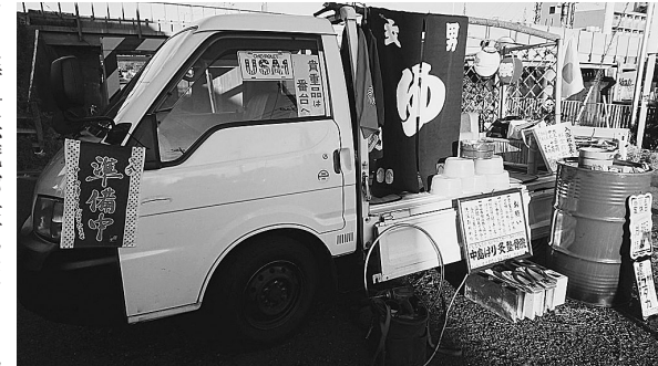
●銭湯は平等になれる場所 1トトラックを買って、D.I.Yで自分で作っています。壁と屋根を張り付ける段階なので、春には完成します。水さえあればどこでもお風呂ができるように、薪や灯油、お湯を沸かす小型のボイラーを積んでいます。浴槽は自分だけが入る時は五石衛門風呂ですが、山梨県のおじやま吉さんの梅田形の桶の浴槽にしました。今、作ってるっていうところ
