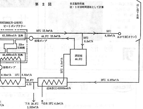
排熱回収ポンプの実験 温水器の効率増大
